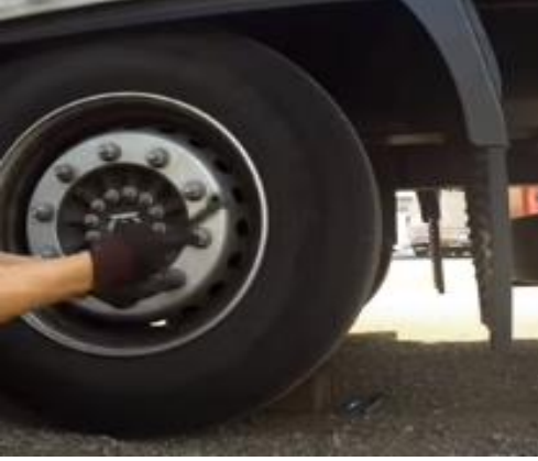
Tekerleğin civatadan gevşetilmesi
