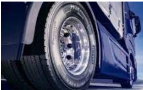
Sot në përdorim janë pneumatikët pa gomë të brendshme të ashtuquajtur - "Tubeless".
